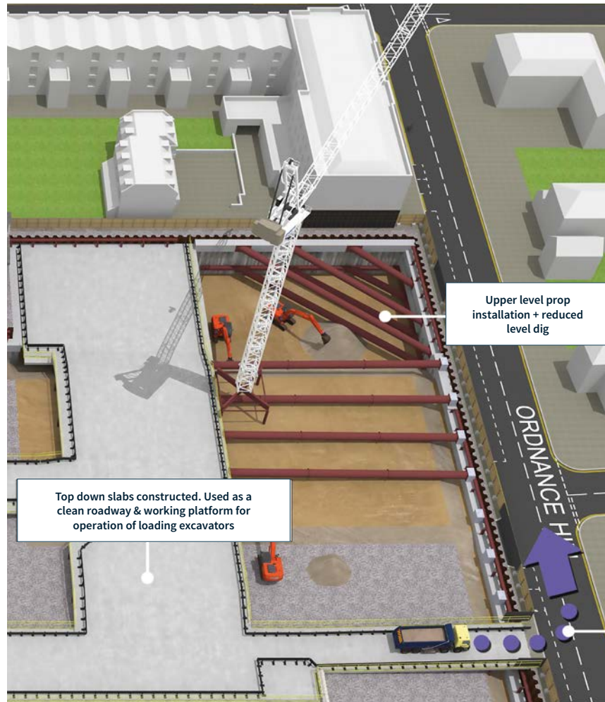
Top Down Dig
